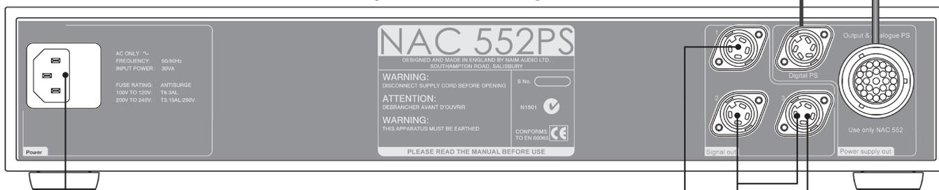
Netzanschluss und Sicherung
