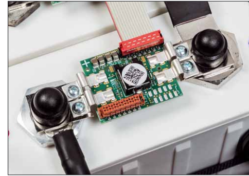
Wachdienst: Jeder der acht Akkus wird von so einer Platine überwacht
