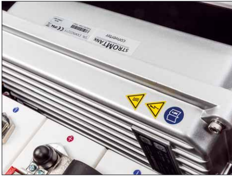
Die Leistungselektronik steckt in abschirmenden und kühlenden Gussgehäusen
